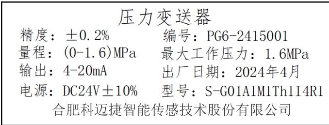
图1.1压力变送器铭牌
