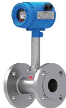
卡曼涡街原理用于流量测量是业内广泛认可的测量手段，压电式涡街流量计因其对介质形态不敏感的特点在各种流量传感器中具有显著的优势，是唯一能够以同一个传感器本体用于气体、蒸汽、液体三种介质测量的流量测量技术，精度高，量程比宽，耐高温，特别是在蒸汽贸易计量的应用有着不可替代的优势。
